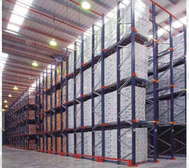
**Diseñado para almacenar pallets de hasta 3000 kg. y de diversas medidas. Responde en forma eficiente a las necesidades creadas en depósitos de mercadería homogénea en los cuales el acceso directo no es un factor determinante.**
